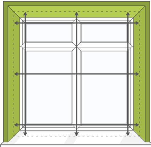
「天井付け※」は窓枠内側におさめる取り付け方法です。本体上部のメカ部分や本体が全て窓枠内に収まるので、すっきりとした印象になるのが特徴です。周囲に家具などを置いた時に干渉しない点もメリットです。
